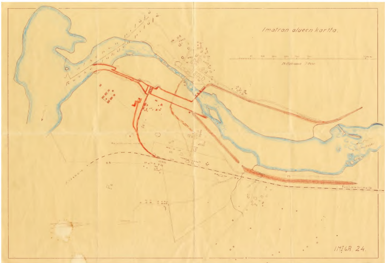
Kuva 3. Kartta, jossa näkyy Vuoksen linjaus ennen padon, kanavan ja voimalan rakentamista sekä punaisella hahmoteltu tilanne niiden rakentamisen jälkeen. Padon avulla muodostettiin voimalan yläpuolelle allas, jota varten rakennettiin rantavallit. Kanavasiltaa ei ole kuvassa esitetty, mutta sen molemmin puolin on tie, joten silta lienee ollut mukana suunnitelmissa jo tässä vaiheessa. Kuva Lappeenrannan museon kuva-arkisto.
