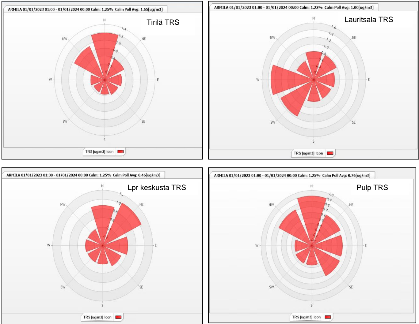
Kuva 33: Tirilän, Lauritsalan, Lappeenrannan keskustan ja Pulpin mittauspisteiden TRS - yhdisteiden pitoisuuskeskiarvojen tuulensuuntajakauma sektoreittain vuonna 2023. Armilan tuulensuunta, tuulennopeus \geq 0,3 m/s
