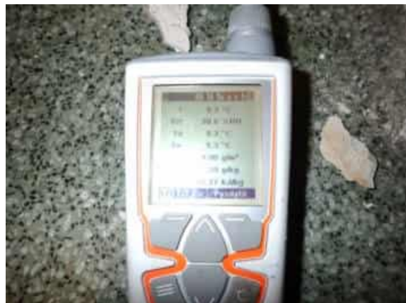
Mittaustulos RH% 99,6, vettä mittausputken juuresta lattialle.
