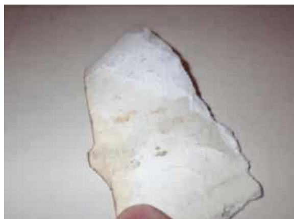
Kosteusjälki kartongin yläpinnalla, vesivaluma kartongin yläpintaa pitkin.
