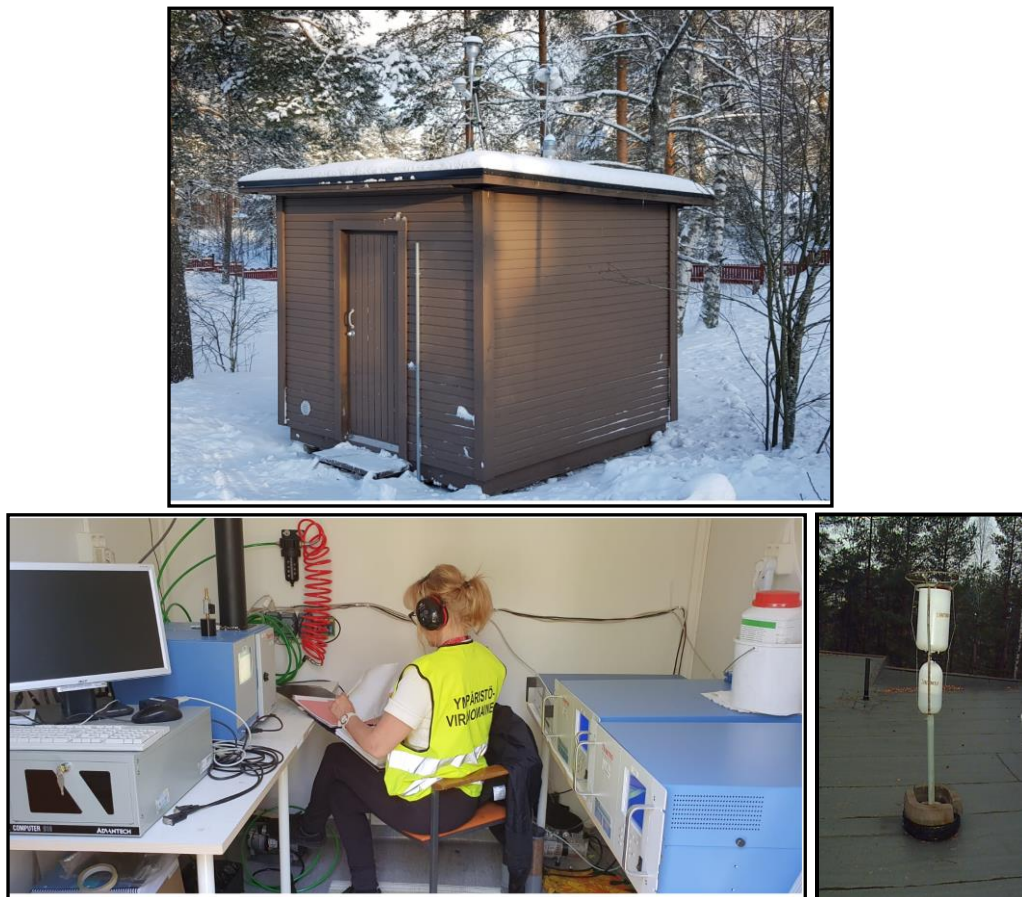
Kuva 8: Rautionkylän ilmanlaadun mittauskoppi, laskeumakeräin ja ilmanlaadun mittalaitteita
