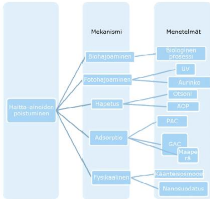
Kuva 26. Haitta-aineiden poistaminen jätevedestä.
