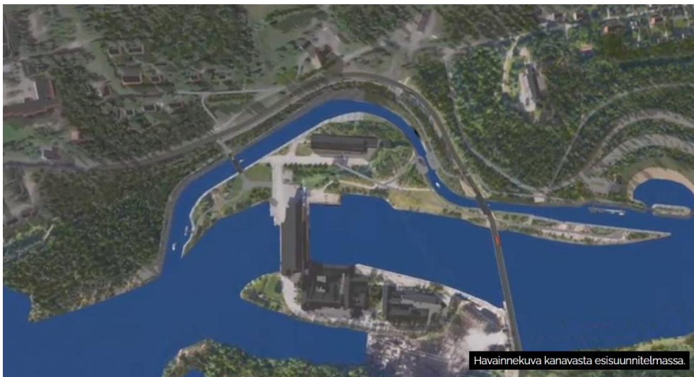
Kuva 12.6. Tainionkosken kanavahanke mahdollistaisi noin 12–15 metriä pitkän veneen kulkemisen Saimaalta Vuokseen. Veneiden lasku ja nosto voisi tapahtua esimerkiksi nostimilla, hissillä tai suluilla. Kanavan esisuunnittelu käsitti Tornansillan ja Mutterinrannan välisen alueen.
